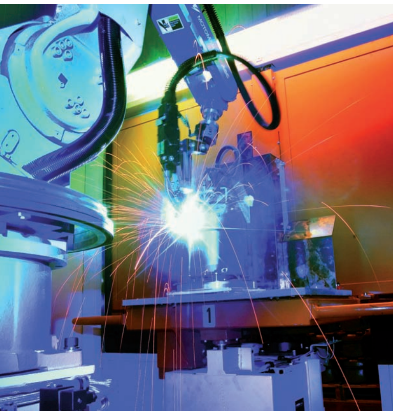
Robotizácia procesu zvárania je len jednou z mnohých aplikácií automatizácie v slovenskom výrobnom závode.
