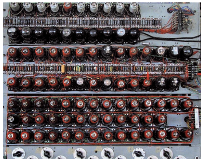
Obr. 7 Vákuové elektrónky – pohľad po obnovení počítača Colossus na konci druhej svetovej vojny, II. éra počítača Colossus v Bletchley Park v Anglicku
