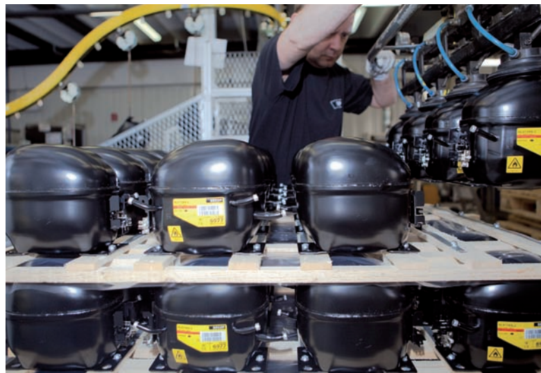
Hermeticky uzavreté kompresory od Secop nachádzajú uplatnenie v komerčných aj mobilných aplikáciách chladenia.
